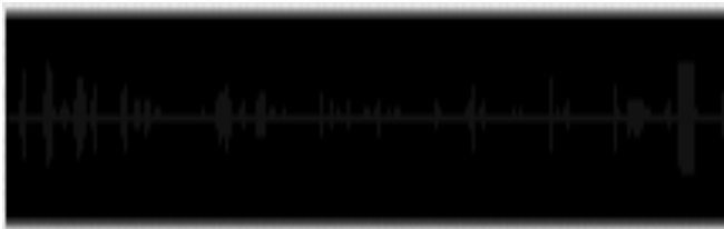
Gambar 11. Sinyal VoIP yang diterima tanpa proses enkripsi dan dekripsi
