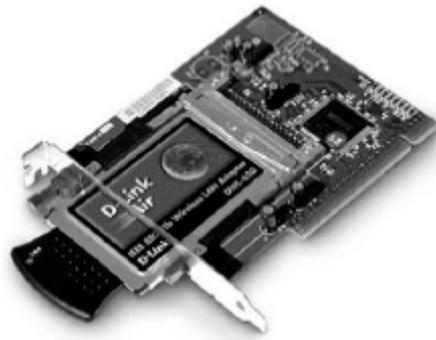
Gambar 4.13. Contoh PCI Adapter
