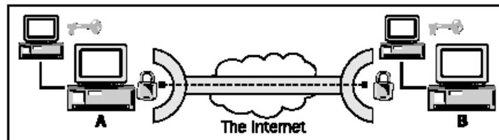
VPN perangkat lunak dalam lokasi A dan B encrypts ( kunci) dan decrypts ( membuka kunci) data dan mengirimkannya melalui tunnel itu. Seperti mobil atau kereta dalam suatu terowongan, data tidak bisa meninggalkan tetapi terowongan yang lain endpoint.
