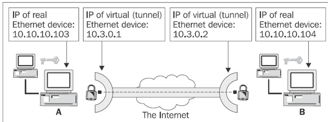
Untuk tunnel openVPN terdiri dari empat jaringan. Dua dari mereka adalah ethernet card yang sesungguhnya dan dua lagi lainnya hanya alat tunnel virtual (TUN atau TAP). Alat jaringan yang sesungguhnya mempunyai IP yang ditetapkan di bawah sistem yang dapat dicapai pada local net. Alat jaringan virtual mempunyai IP yang ditetapkan untuk digunakan set up tunnel.
