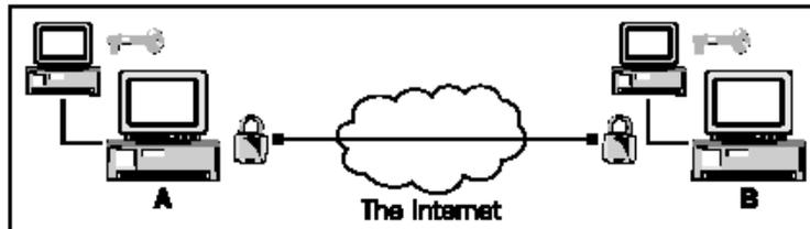
Semua data dikirim dari Sydney ke London atau dari London ke Sydney harus terenkripsi sebelum dan didekripsi setelah transmisi. Encryption melindungi data di dalam koneksi seperti dinding dari suatu terowongan melindungi kereta dari gunung di sekitar itu. Ini menjelaskan mengapa VPN sering dikenal sebagai terowongan (tunnel) atau VPN tunneling, dan teknologinya sering disebut tunneling—even jika tidak ada mekanika kuantum lain yang melibatkan.
